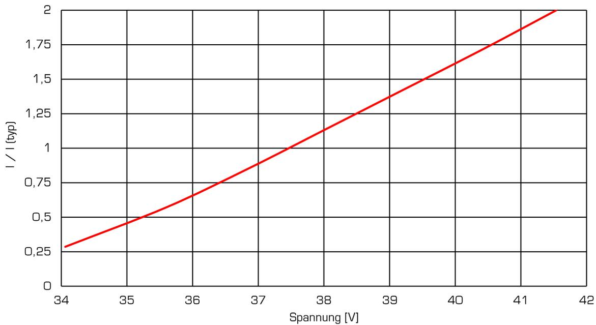
**LICHTSTROM vs. SPANNUNG**
