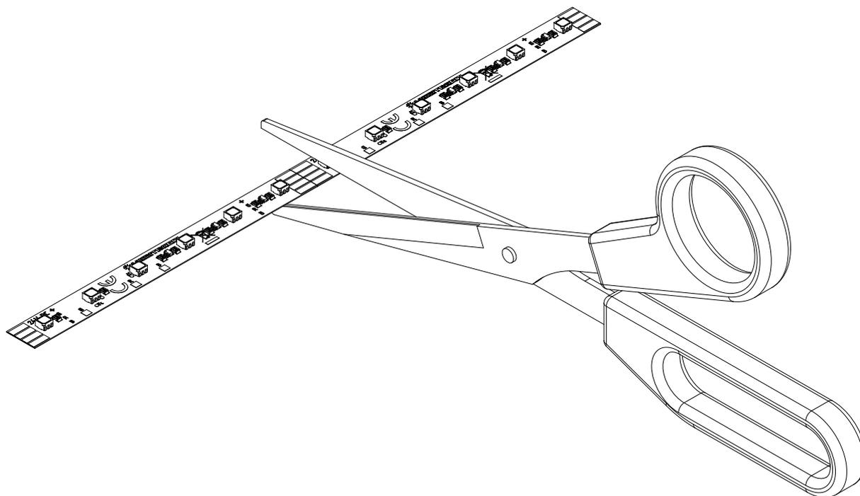
Die LumiFlex Performer RGB LED Leisten können alle 100 mm getrennt bzw. gekürzt werden. Auf der Rückseite der LED Leiste befindet sich ein doppelseitiges wärmeleitendes Klebeband, wodurch eine einfache und schnelle Montage der LED Leiste möglich ist. Dadurch können Sie nahezu alle Flächen und Formen direkt oder indirekt beleuchten. Zum Kürzen der LumiFlex Performer RGB LED Leisten kann eine Schere verwendet werden.
