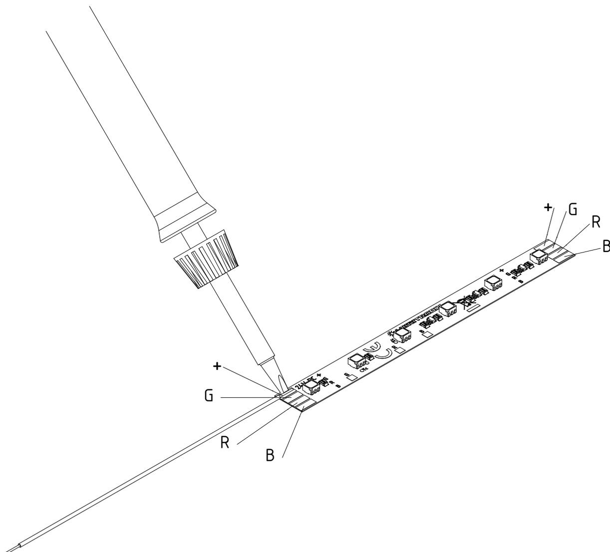
Der Anschluss der LumiFlex Performer RGB LED Module erfolgt über eine Lötverbindung an den dafür vorgesehenen Anschluss pads. Alternativ können gängige RGB-Verbinders verwendet werden.
