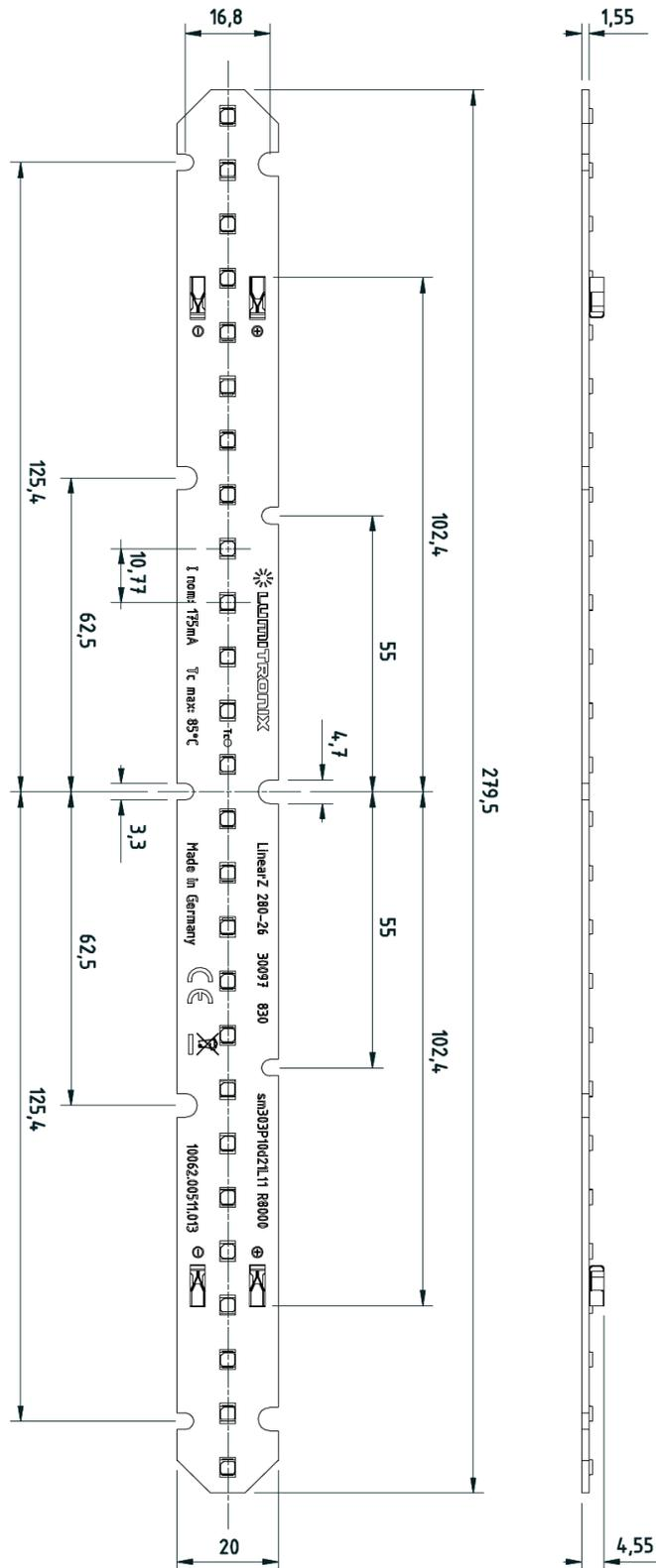
LUMIBAR-26-3098+ TOSHIBA-SSC LED STRIP SUNLIKE CRI98 WARM WHITE 3000K 685LM 175MA 39.6V 26 LEDS 28CM MODULE
